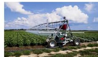
لوجود العديد من الاختيارات لمشاريع الري يمكن تجهيز جهاز الري بمجموعة كاملة من بخاخات المياه تعمل على الضغط العالي أو الضغط المنخفض مع توصيات لتقويب رش الماء من الأرض حتى تضمن معدلات الماء المناسبة لقابلية التربة لامتصاص الماء و زيادة كفاءة الري.
